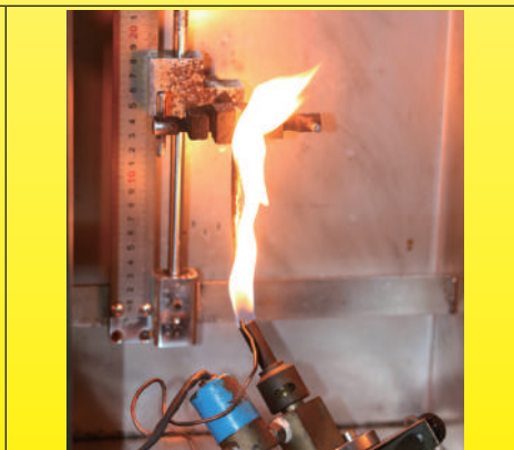
Образец во время испытания на UL94VO
